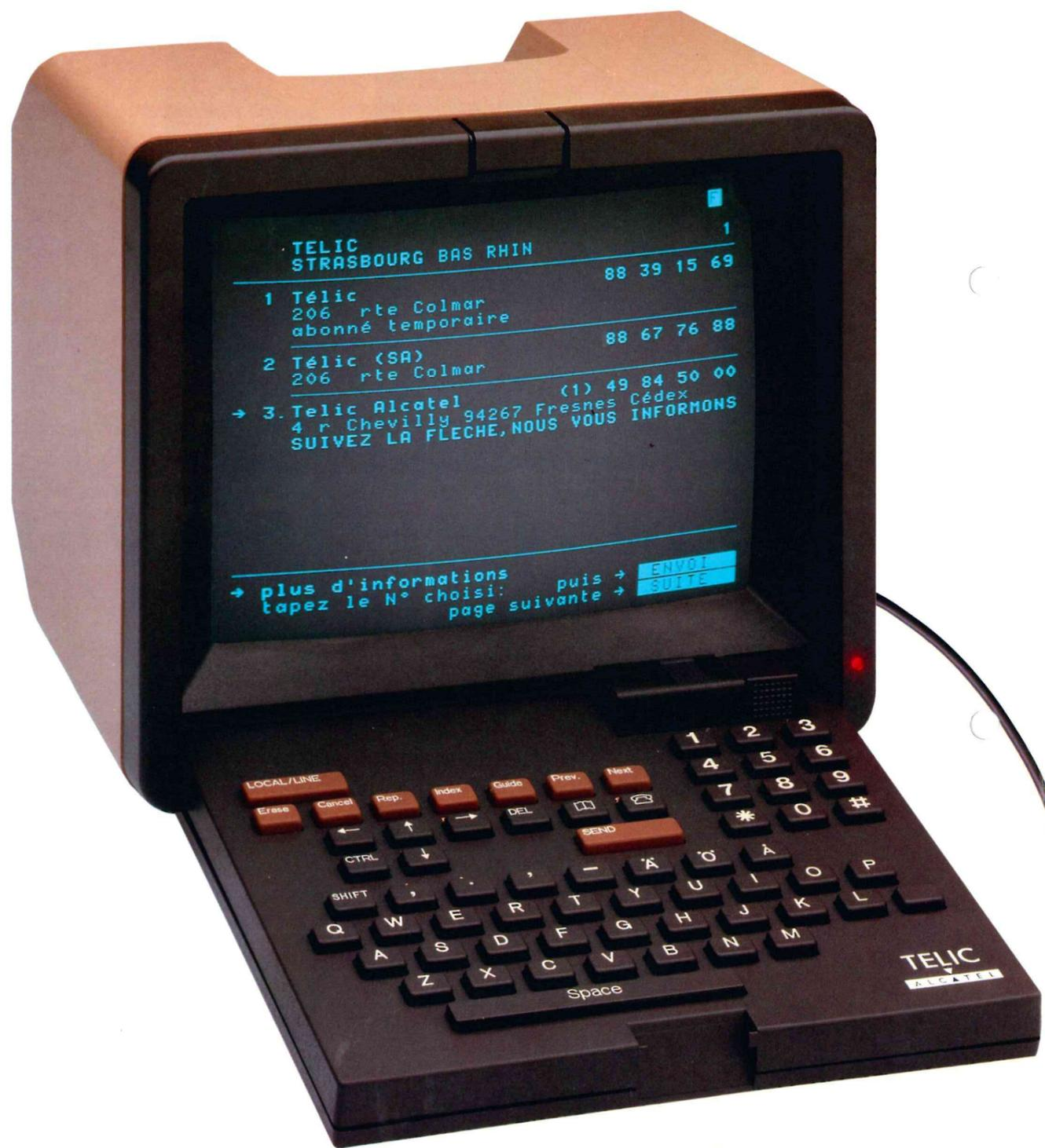
**Le Terminatel 254 est l'héritier direct du Minitel, le terminal vendu à plus de 3 millions d'exemplaires. Tri-standard, il allie le mode de communication téléinformatique le plus courant (ASCII) aux deux standards Vidéotex les plus répandus dans le monde (Télérel et Prestel).**
